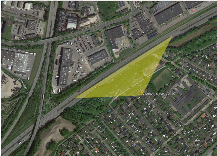
Figur 6: Placering af målepunktet Vibeholms Vænge 109 og vinkelområde for vindretninger, der opfylder den meteorologiske ramme for måling af støjen fra Køge Bugt motorvejen
