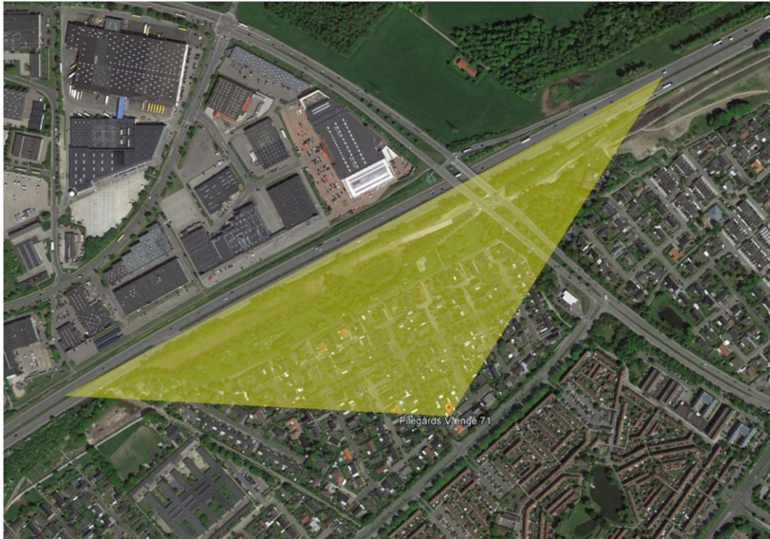
Figur 2: Placering af målepunktet Pilegårds Vænge 71 og vinkelområde for vindretninger, der opfylder den meteorologiske ramme for måling af støjen fra Køge Bugt motorvejen
