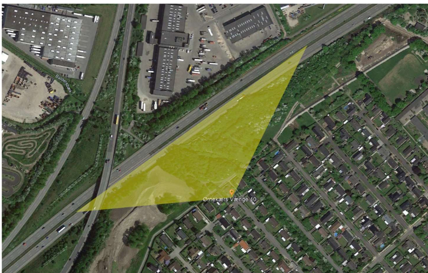
Figur 8: Placering af målepunktet Ørnekærs Vænge 40 og vinkelområde for vindretninger, der opfylder den meteorologiske ramme for måling af støjen fra Køge Bugt Motorvejen
